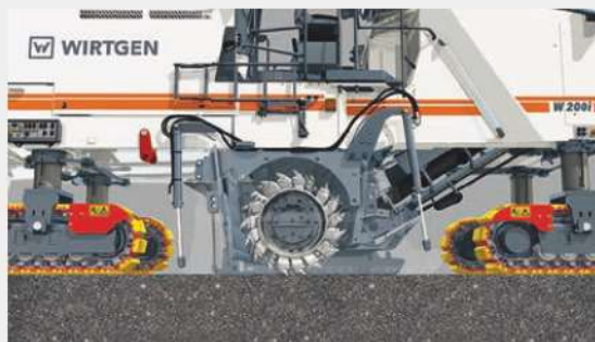
2 | 平行アライメントで機体の水平姿勢を保ちながら降下
