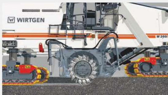
4 | スタート位置から、必要切削深さで施工開始
