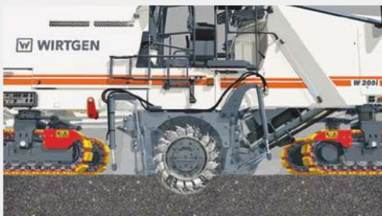
3 | 水平姿勢を保ったままゆっくりとドラムを作業位置まで降下
